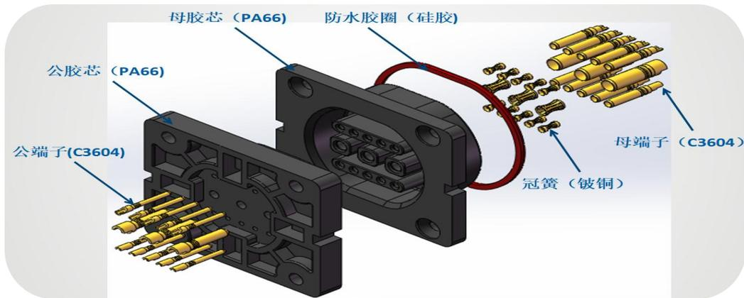
防水，防震，防打火，正反插，6000次寿命，电池连接器
